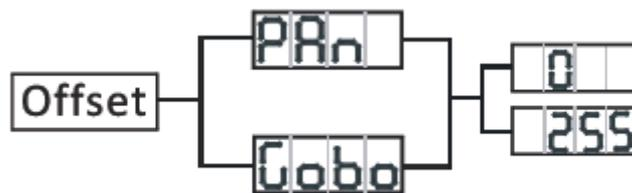
Um das Untermenü für die Einstellung der Anfangsposition zu öffnen, betätigen Sie für mindestens 5 Sekunden die ENTER-Taste. In diesem Untermenü können Sie die Anfangsposition der Schwenkung und die Position des Goborads einstellen.
